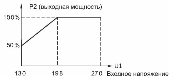
Рис. 1 Кривая выходной мощности Когда напряжение от однофазного стабилизированного источника напряжения падает ниже 198 В, выходная мощность изделия уменьшается. Изделие нужно использовать после уменьшения мощности.
